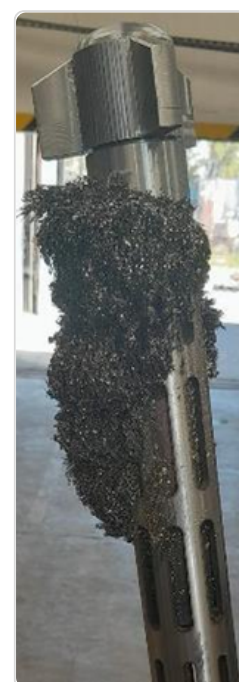
Fig. 2 - Estado filtro magnetico post corrida
